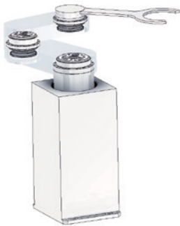
晶圆搬运机器人 Wafer-transfer Robot
