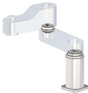
SCARA机器人 SCARA Robot
