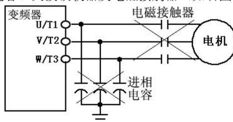
3. 勿使用電源線上的「電磁接觸器」或「無熔絲開關」來啟動與停止電機。
