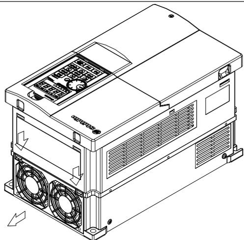
2. 斷開風扇接頭後，將風扇取出，如下圖所示。
