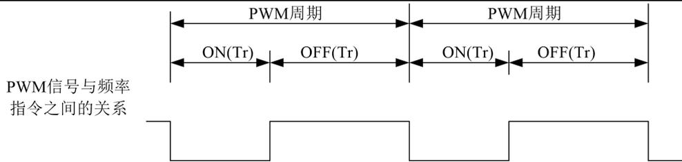
$$\text{频率指令值 (Hz)} = \frac{\text{ON时间}}{\text{PWM周期}} \times \text{上限频率 01-00(P.1) (Hz)}$$
