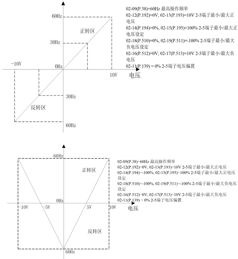
例 10：此例為帶偏壓的應用。偏置電壓由 02-11(P.139)設置，當 02-11(P.139)為 0%時表示無偏壓，大於 0 時表示正向偏壓，小於 0 為反向偏壓。
