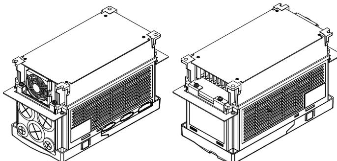
3. 將螺絲 3\*4 (M4\*8) 與 Accessories 2&3&4 鎖住(如下圖所示)。『螺絲扭力值: 20~25kg-cm』
