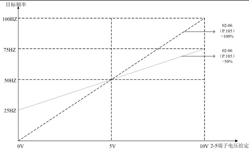
圖中：在 0V 時，目標頻率為  $50\text{Hz} - (50\text{Hz} \times 50\%) = 25\text{Hz}$
