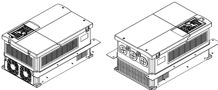
2. 將螺絲 1 \* 4 (M6) 與 Accessories 1&2 鎖住(如下圖所示)。『螺絲扭力值：65~75K/90KFg-cm』
