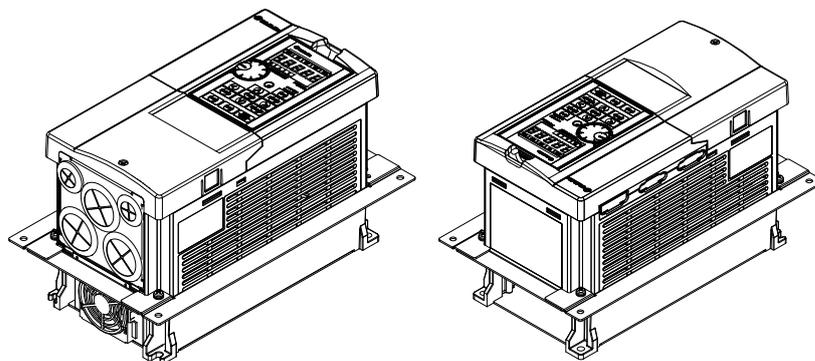
4. 將螺絲 2\*4 (M6\*15) 穿過 Accessories 2&3&4 與配盤鎖住(如下圖所示)。【扭力值：65~75K/90KFg-cm】
