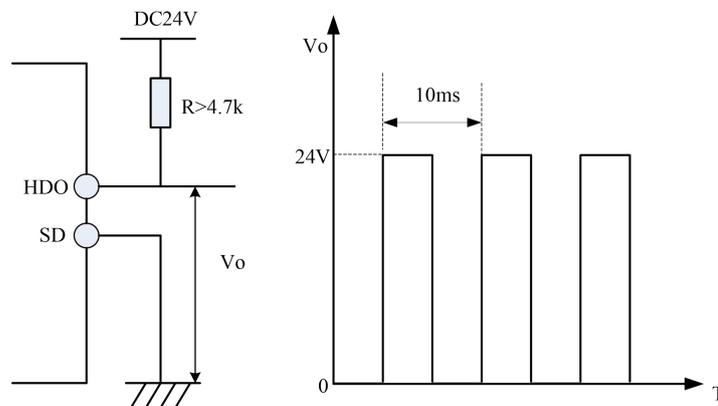
注：當 02-43(P.74)=1 時為 1 倍率輸出，變頻器可提供 1~650Hz 精度為 1% 的輸出。當 02-43(P.74)倍率設定越大且運轉頻率越大時，精度會變差。
