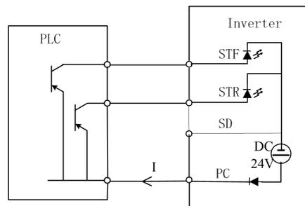
Source Input: 多功能控制端子与开发射极的PLC直接相连接
