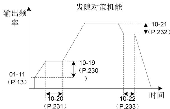
注：設定了齒隙補償時，加減速時間中僅中斷時間部分變長。
