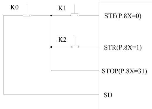
◆ 三線控制模式 2 (帶自保持功能) : K1 為 STOP 功能, 常閉, 斷開時停止; K2 為 RUN 信號, 常開, 脈衝信號有效, 即點動有效。當換向信號 (STF/STR) 數字輸入端子對應相關參數設定為 39 時, 換向時, 先停車, 需再 RUN 後才會啟動。
