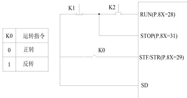
◆ 外部模式下, 當 PO 「on」時, 選擇程式運行模式。此時, STF 端子為啟動信號來源, 當 STF 「on」時, 開始程式運行 (從第一段開始運行), STF 「off」時, 停止程式運行; STR 為暫停信號來源, 當 STR 「on」時, 運行暫停, STR 「off」時, 繼續運行 (從暫停時的那段開始運行)。具體參數請參考 04-15(P.100)、04-27(P.100)~04-42(P.118)、04-16(P.121)~04-18(P.123)、04-19(P.131)~04-26(P.138)。
