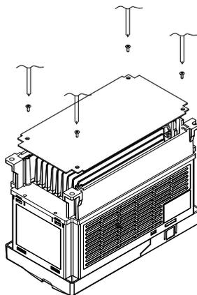
2. 將螺絲 3\*4 (M4\*8) 與 Accessories 3&4 鎖住(如下圖所示)。『螺絲扭力值: 20~25kg-cm』
