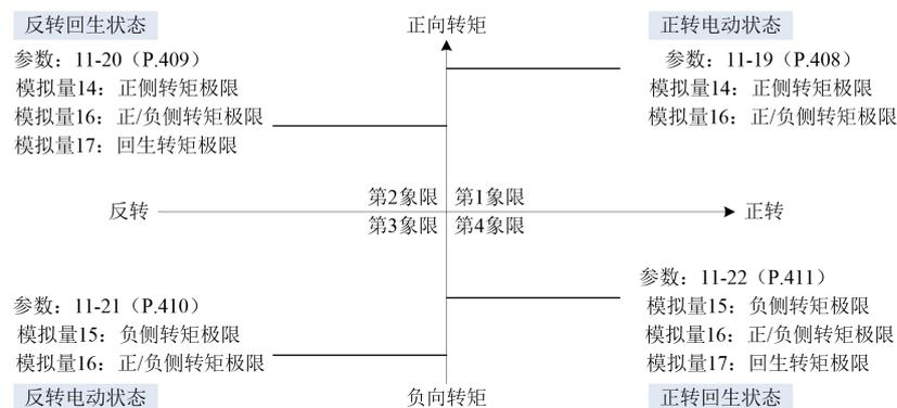
◆ 在通過參數設定的轉矩極限、通過模擬量設定的轉矩極限、通過 06-01(P.22)設定的變頻器輸出電流限制中，最小的轉矩極限有效。
