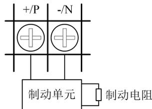
注：框架 D、E、F、G、H 對應的變頻器無內置制動單元，可選配 BKU 制動單元和制動電阻詳見 7.4.6； 框架 A、B、C 對應的變頻器內置制動單元可選配制動電阻。框架的說明請參考 3.3 節。
