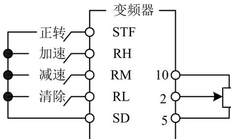
2. 若 10-11(P.61)=1~4，變頻器的目標頻率 =（RH、RM 操作時設定的頻率 + 多段速以外的外部設定頻率/PU 設定的頻率）；
