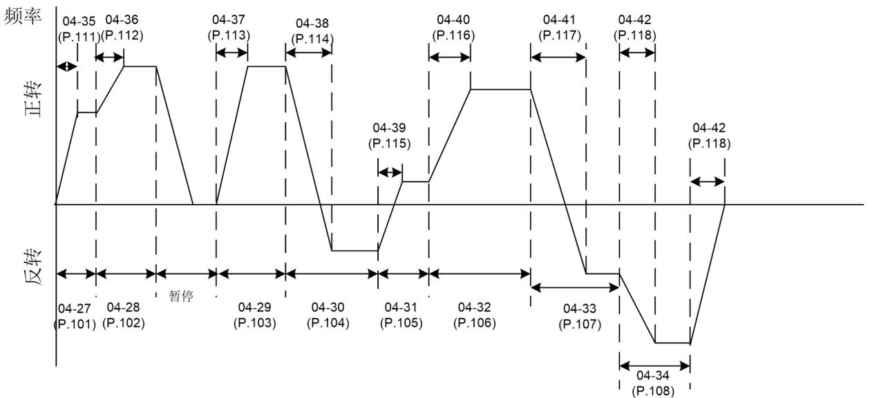
2. 運行方向的設定是以二進位 8bit 的方式設定再轉化為十進位的形式輸入參數 04-16(P.121)中，1 表示正轉，0 表示反轉，最高位為第八段速方向，最低位為第一段速方向。
