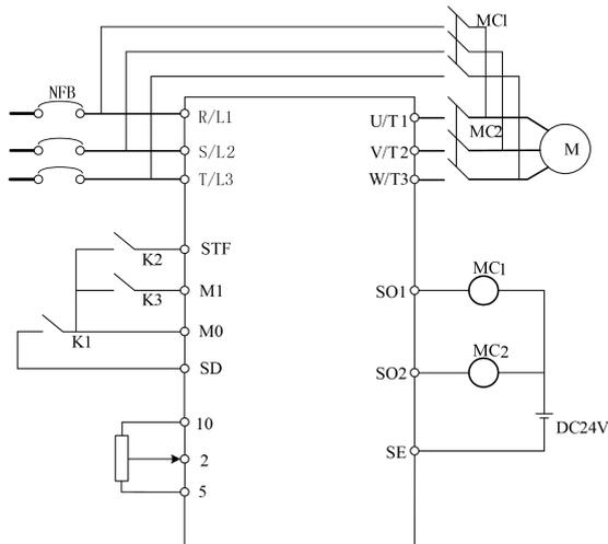
請注意輸出端子的容量。使用的端子根據 03-10(P.40)、03-11(P.85)、03-12(P.129)、03-13(P.130) (輸出端子功能選擇) 的設定而不同。輸出端子功能選擇 10 時，接驅動工頻的繼電器，輸出端子功能選擇 9 時，接驅動變頻的繼電器。數字輸入端子功能選擇 37 時，選擇工頻運行切換功能；輸入端子功能選擇 38 時，手動工頻變頻切換信號 CS。
