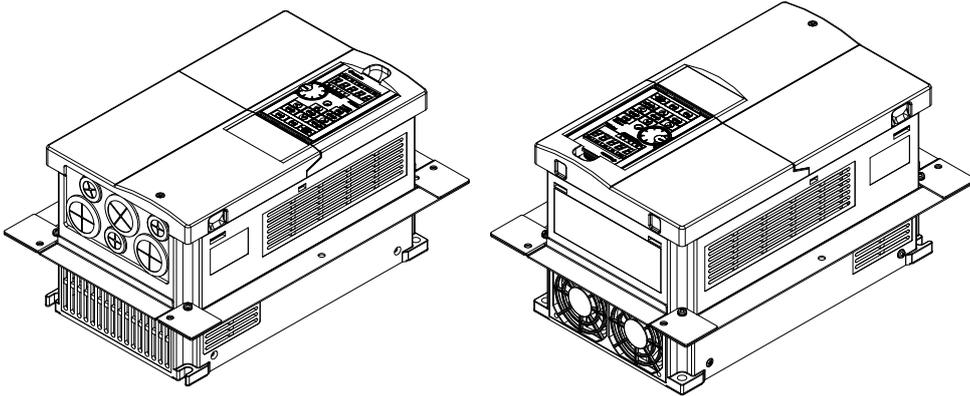
3. 將螺絲 1\*6 (M6) 穿過 Accessories 1&2 與配盤鎖住(如下圖所示)。【螺絲扭力值：65~75K/90KFg-cm】
