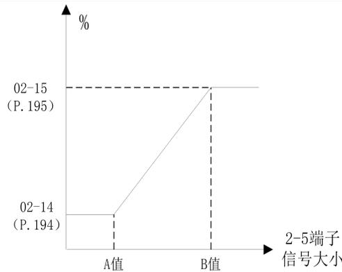
例 1.2: 用戶先設置好 02-14(P.194)和 02-15(P.195)的值，再設置 02-12(P.192)和 02-13(P.193)。如下圖所示:
