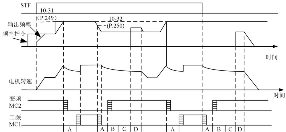
自動切換時，A: 10-29 (P.247)MC 切換互鎖時間，B: 10-30(P.248) 啟動等待時間，C: 10-09(P.57) 再啟動自由運行時間，D: 10-10(P.58) 再啟動上升時間。
