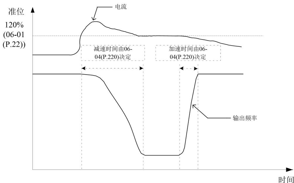
圖中的電流是指電流的幅值。
