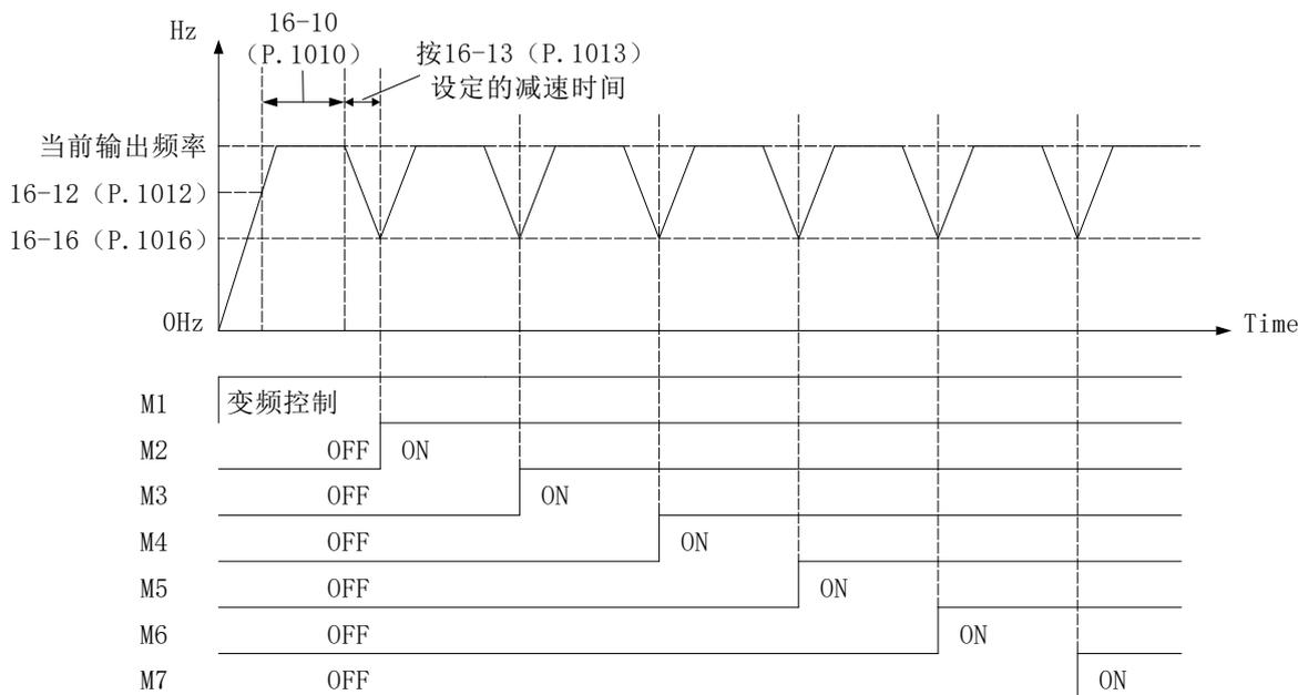
1 臺變頻泵+6 臺工頻泵加泵過程
