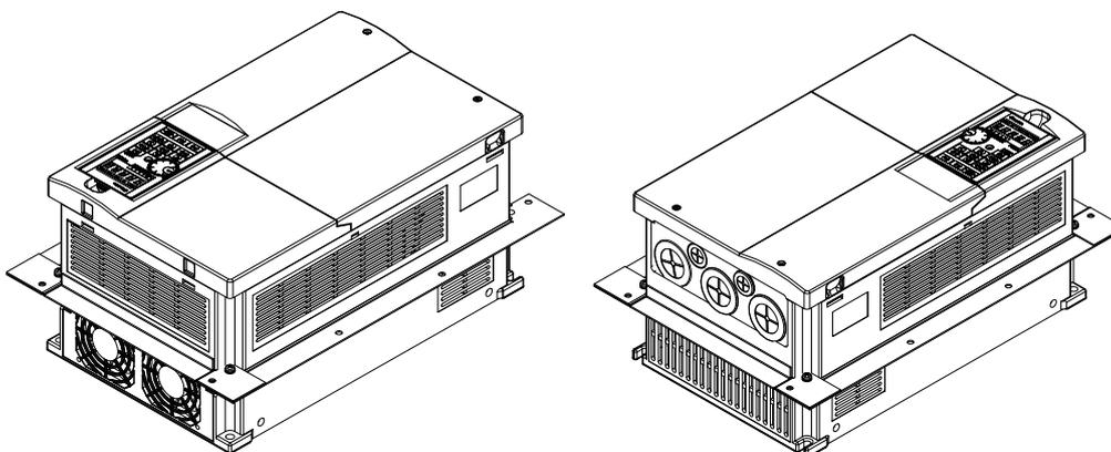
3. 將螺絲 1\*8(M6) 穿過 Accessories 1&2 與配盤鎖住(如下圖所示)。『螺絲扭力值：65~75K/90KFg-cm』
