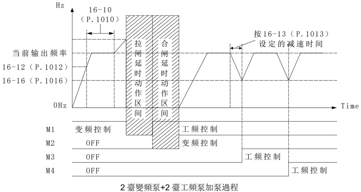
若設置 16-35 (P.1050) 為 0，加泵順序按照先加完所有的變頻泵再加工頻泵基礎上，按最短運行時間進行加泵，所以第一個加泵為變頻泵，其次工頻泵按照時間參數 16-40(P.1055)~16-43(P.1058)，從最短運行時間的泵進行加泵。
