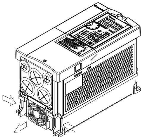
2. 斷開風扇接頭後，將風扇取出，如下圖所示。
