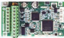
PG302L 速度回授卡 (支持 Resolver 信號)
