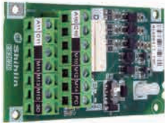
PG302L 速度回授卡 (支持 Resolver 信號)
