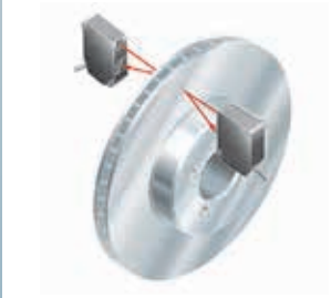
测量制动圆盘的厚度
