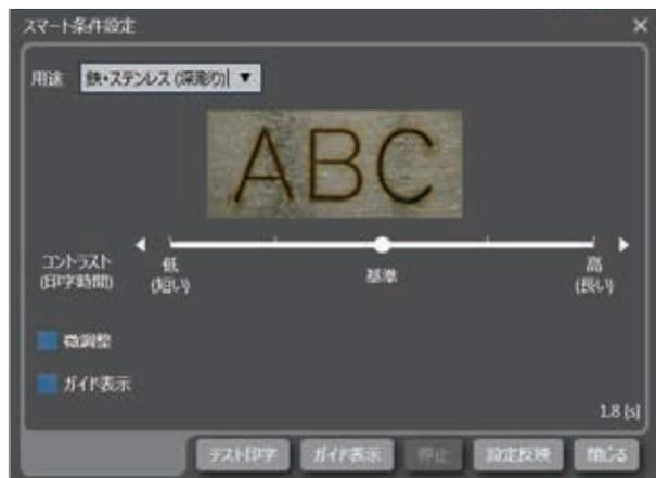
將雷射功率、掃描速度、脈衝頻率等刻印條件的設定訣竅集中到一鍵式功能 (one touch)。從多達14種材質的圖像中，一鍵選擇所需要的刻印狀態。
